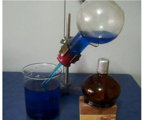
Resim 4. Kapalı kaptaki gazın büzülme olayı sonunda oluşan durum
