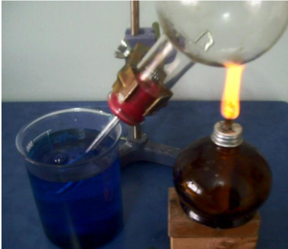
Resim 3. Kapalı kaptaki gazın genişleme sonucunda su içinden gaz çıkışı
