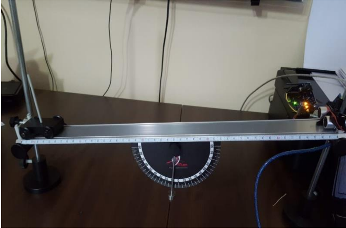
Şekil 4. Eğik düzlem üzerinde serbest bırakılan oyuncak arabanın yaptığı hareketi incelemek için kullanılan bilgisayar destekli sistem.
